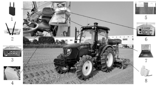
1. 车载路由器 Vehicle router; 2. 播种监测终端 Seeding monitoring terminal; 3. 转向控制箱 Steering control box; 4. 液压机构控制箱 Hydraulic mechanism control box; 5. 播种监测云平台 Seeding monitoring cloud platform; 6. 北斗RTK移动站 Beidou RTK mobile station; 7. 车载计算机 Vehicle computer; 8. 种子流传感装置 Seed flow sensing device.
