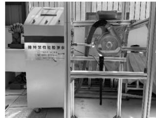
图9 排种器性能检测仪
