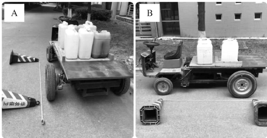
图 11 制动性能试验现场后视图(A)与侧视图(B)
