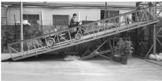
图 3 运输车最大爬坡度台架试验
