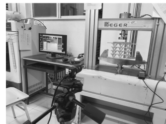
图 2 双 V 附翼型蜂窝结构 Y 方向压缩试验
