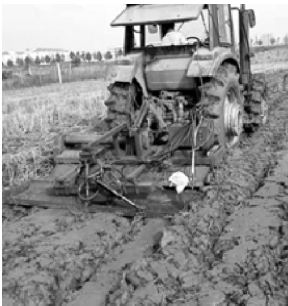
图 7 配备采用倾角传感器平地系统的水田旋耕机统试验
