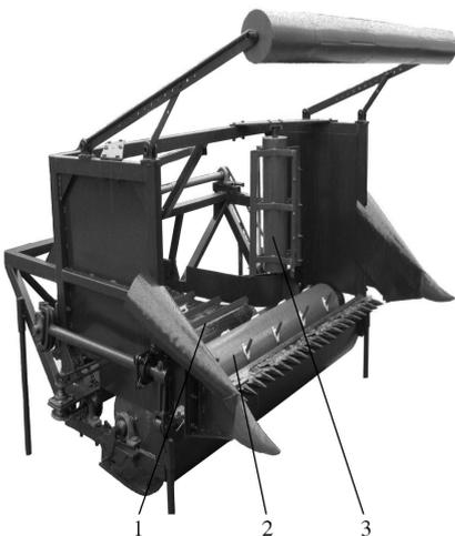
1. 输送带总成 Conveyor; 2. 伸缩滚筒总成 Telescopic cylinder; 3. 立辊总成 Vertical cylinder.
