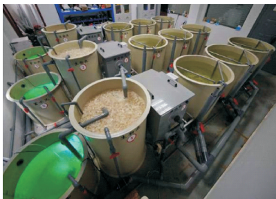
图1 循环水养殖试验平台
