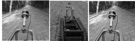
A: 水泥路面 Cement pavement; B: 泥土路面 Soil road; C: 砂石路面 Sand and gravel road.
