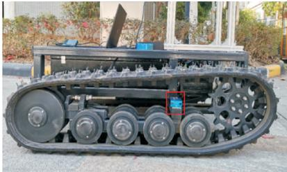
图15 加速度传感器安装位置
