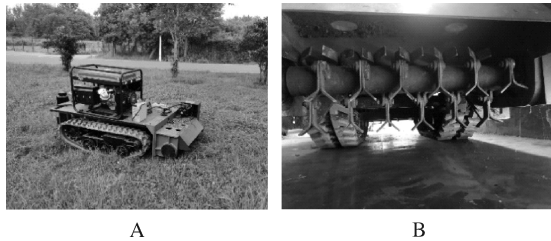
图10 割草机器人样机(A)及甩刀结构实物(B)
