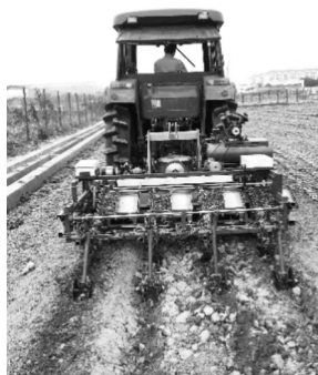
图12 油菜基质块苗移栽机田间运行图
