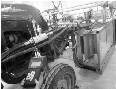
图 4 压力和流量采集试验
