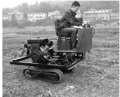
图 5 田间底盘测速试验
