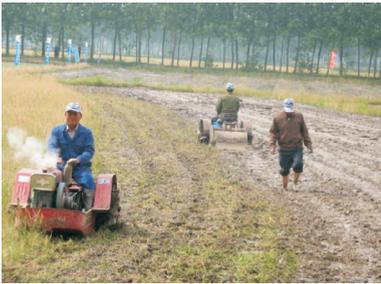
图 1 船式旋耕埋草机
