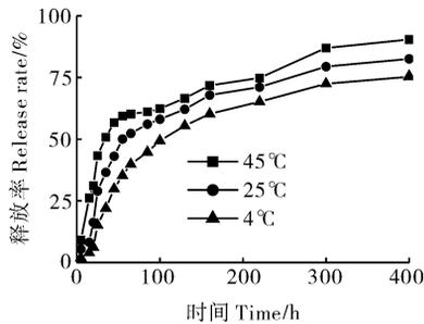
图 2 不同温度下微胶囊的释放率
